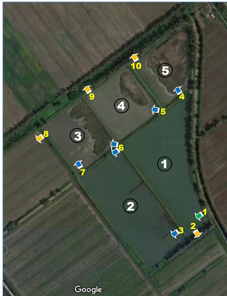
Figura 7 - Sistema di chiuse per la gestione idrica del sito.
